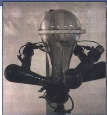
possibile utilizzare triodi ma per correnti notevoli si opta per i Tyratrons, valvole non dissimili ai nostri SCR. Esistono Tyratrons polianodici e monoanodici. Le figura 13 e 14 mostrano semplici circuiti di utilizzo di questi ormai rari tubi termoionici. I Tyratrons sono tuttora utilizzati in apparecchiature ad altissima corrente quali certi tipi di laser, alimentatori
